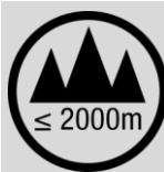
**標誌含義：**加貼該標誌的設備僅按海拔 2000m 進行安全設計與評估，因此，僅適用於在海拔 2000m 以下安全使用，在海拔 2000m 以上使用時，可能有安全隱患。
