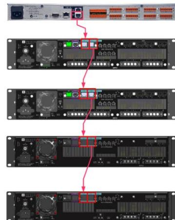
数字音频是通过菊花链连接，从一个设备传送到下一个使用标准 Cat5e 跳接线的设备。将 SDEC4500P 的 OUT (输出) 连接至第一个功放的 IN (输入)。继续连接系统内每一个功放，将 OUT (输出) 连接至 IN (输入)。最多可连接 60 个功放，支持 128 个离散声道。
